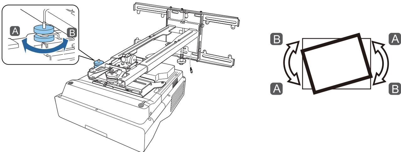
**4** Tournez le cadran d'ajustement **2** dans le guide d'installation pour ajuster la rotation horizontale
