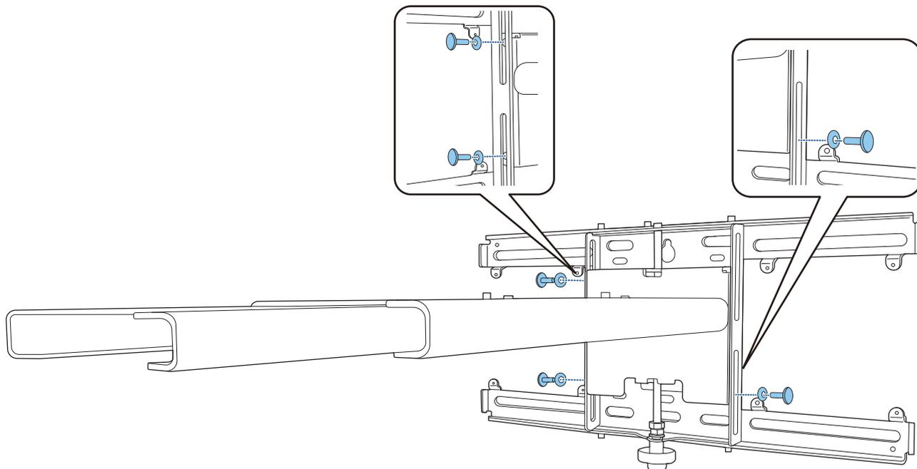
**6** Tournez le bas de l'axe hexagonal avec une clé à cliquet de 17mm jusqu'à aligner les marques sur la plaque murale et la plaque d'installation
