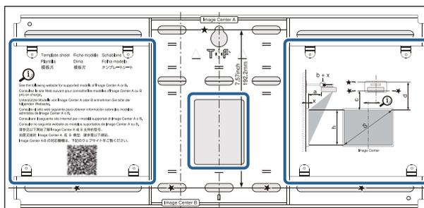
Lors de l'installation d'un mini-PC ou d'un PC portable, vérifiez la position à laquelle la plaque du mini-PC sera installée avant de percer les trous d'acheminement des câbles. ( p.60)
