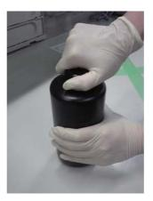
Tenez fermement le bidon d'encre et utilisez un outil pour percer un trou dans la protection.
