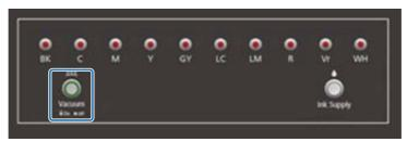
2-2 Ouvrez la vanne en fonction de la position dans laquelle le support est chargé. Le support adhèrera à la table.
