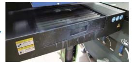
Appuyez sur le bouton à l'avant de l'imprimante pour la mettre hors tension.
