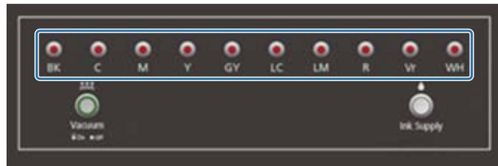
Se a tinta se esgotar durante a impressão e a impressão for colocada em pausa, pode retomar a impressão reenchendo os tinteiros de tinta. No entanto, se reencher de tinta durante a impressão, as cores podem parecer diferentes consoante a forma como a tinta seca. Se souber que vai imprimir grandes trabalhos com antecedência, recomendamos que reencha todos os tinteiros de tinta cujo nível esteja baixo antes de começar a imprimir.
