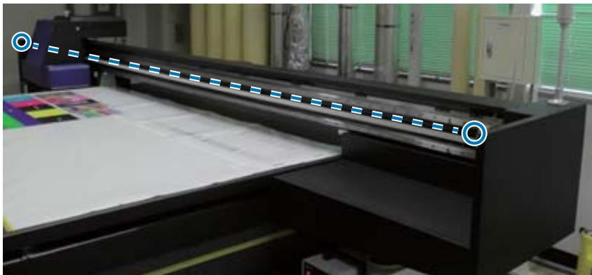
Se alguém se aproximar da zona limite de funcionamento do carro, este sensor deteta o movimento e para imediatamente o carro. Os sensores estão instalados nas posições mostradas na fotografia.
