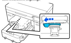
Bewegen Sie den Hebel eine Kerbe nach rechts, um die Position zu finden, an der das Fehlersignal stoppt.
