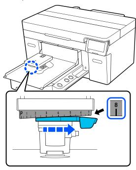
Ziehen Sie den Fixierhebel fest und sichern Sie dann den Hebel für Plattenabstand.
