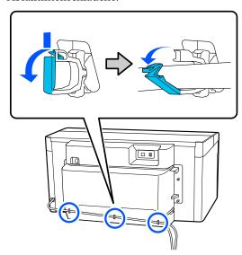
Entfernen Sie die Befestigungsschrauben der hinteren Abdeckung.
