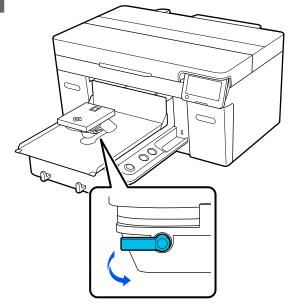
Drücken Sie den Hebel für Plattenabstand nach rechts, um die Skala auf 8 einzustellen.
