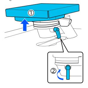
Heben Sie den Hebel für Plattenabstand an und entfernen Sie den Abstandhalter.
