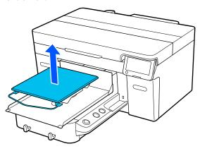
Wenn die ummantelte Platte installiert ist, entfernen Sie das Befestigungsband, bevor Sie die Platte anheben.
