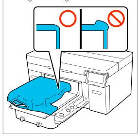
Verwenden Sie das mitgelieferte Griffpolsterwerkzeug, um die zu bedruckende Oberfläche zu glätten. Das T-Shirt haftet am Griff der Trägerplatte, wodurch es flach anliegt und sich während des Druckvorgangs nicht bewegt.
