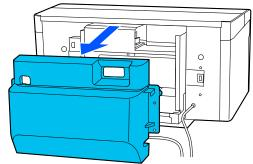
Entfernen Sie die Abfalltintenschläuche, indem Sie sie von unten mit einem Reinraum-Wischer anfassen, wie in der Abbildung gezeigt, damit die Abfalltinte aus dem Abfalltintenauslass auswischen.
