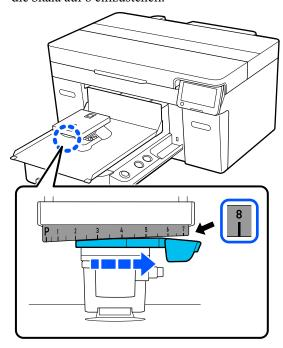
Ziehen Sie den Fixierhebel fest, während Sie das in der Abbildung gezeigte ① Teil anheben, um den Hebel für den Plattenspalt in der angehobenen Position zu sichern.
