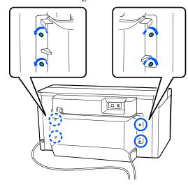
Entfernen Sie die hintere Abdeckung.
