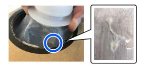
Dies geschieht aufgrund einer Klümpchenbildung in der Fixiererkomponente der Vorbehandlungsflüssigkeit. Wenn Sie die Vorbehandlungsflüssigkeit ungefiltert mit Klümpchen verwenden, werden die Druckergebnisse ungleichmäßig sein. Daher müssen diese herausgefiltert werden.
