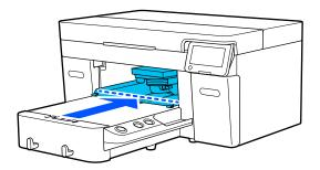
Bringen Sie das Befestigungsteil an, das Sie während der Installation entfernt haben, und sichern Sie es mit der Schraube.
