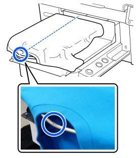
Begradigen Sie die Druckoberfläche, indem Sie die über die Platte hinausragenden Teile des Shirts straff ziehen.
