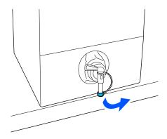
Öffnen Sie den Hebel, um einen Liter der Vorbehandlungsflüssigkeit durch den Filter in die Flasche zu gießen.
