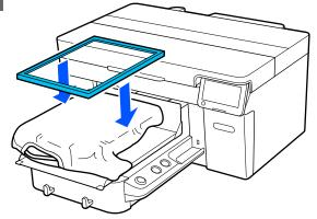
Entfernen Sie Fussel von der Druckoberfläche und drücken Sie die Fasern flach.
