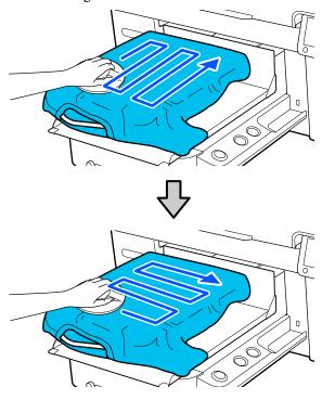
Verwenden Sie beim Auflegen eines mit Vorbehandlungsflüssigkeit beschichteten T-Shirts oder wenn sich das Griffpolsterwerkzeug aufgrund der Textileigenschaften verfängt das Griffpolsterwerkzeug mit einer Schutzfolie wie beispielsweise Silikonpapier auf dem T-Shirt, wie in der Abbildung gezeigt.
