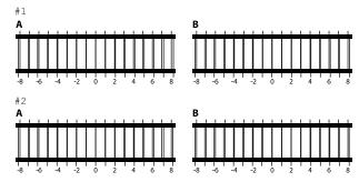
Prüfen Sie die zwei Muster A bis B in jedem Block und wählen Sie aus -8 bis +8 die Zahl der dünnsten Linie des Musters (Linien überlappen sich).
