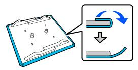
Legen Sie die Trägerplatte auf eine ebene Fläche. Die Oberfläche muss sichtbar sein und drücken Sie dann auf die Vorderseite.
