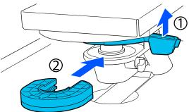
Lösen Sie den Fixierhebel, während Sie das in der Abbildung gezeigte ① Teil anheben.
