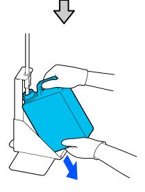
Schieben Sie den Abfalltintenschlauch in die Öffnung der neuen Abfalltintenflasche und platzieren Sie die Abfalltintenflasche wieder am Halter.
