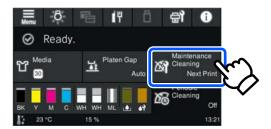
Die Bedienbereiche führen Bedienvorgänge aus, wenn Sie darauf drücken. Bei eingeblendeter Scrollleiste können Sie wie unten gezeigt durch den Bildschirm scrollen, in dem Sie Ihren Finger auf dem Bildschirm nach oben und unten bewegen (führen). Sie können zum Scrollen auch auf die Aufwärts- und Abwärtssymbole auf der Scrollleiste drücken.
