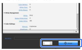
Sobald der Drucker einen Auftrag vollständig empfangen hat, öffnet sich im Bildschirm des Druckers die Vorschauanzeige und die Schaltfläche  $\diamondsuit$  fängt an zu leuchten.
