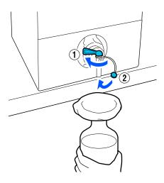
Wenn Sie weitere Vorbehandlungsflüssigkeit filtern möchten, ersetzen Sie den Filter durch einen neuen und wiederholen Sie dann den Vorgang ab Schritt 2.
