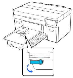
Drehen Sie den Hebel im Uhrzeigersinn, um die Skala auf 8 einzustellen.
