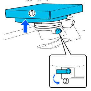
Lassen Sie das Teil los, das im vorherigen Schritt angehoben wurde, und ziehen Sie den Fixierhebel wieder an, um den Hebel für den Spaltenabstand zu sichern.
