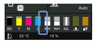
Die Trennlinie zwischen C und WH zeigt an, welche Tintenfarbe von der Vorderseite des Druckers aus gesehen im Innern der linken oder rechten Tintenklappe eingelegt ist.
