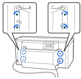
11 Снимите заднюю крышку.
