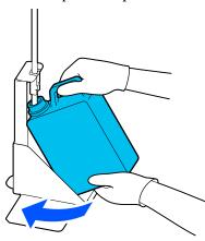
Тщательно запечатайте отверстие на использованной Емкости для отработанных чернил.
