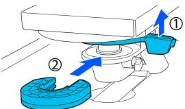
Ослабьте фиксирующий рычаг, поднимая показанную на рисунке деталь ①.
