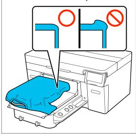
Для разглаживания поверхности печати используйте прилагаемый к принтеру разглаживатель. Футболка прикрепляется к противоскользящей прокладке печатного стола, которая сохраняет ровную поверхность печати и предотвращает сдвиг футболки во время печати.
