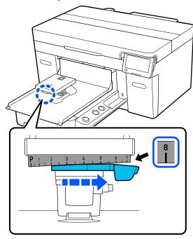
Затяните фиксирующий рычаг, поднимая показанную на рисунке деталь ①, чтобы зафиксировать рычаг регулировки зазора печатного стола в поднятом положении.
