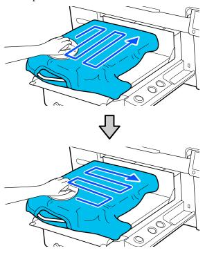
Если загружается футболка с нанесенной жидкостью для предварительной обработки или если разглаживатель цепляется за ткань, то при использовании разглаживателя поместите на футболку антиадгезионный лист, например силиконовую бумагу, как показано на рисунке.
