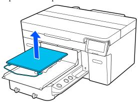
Если установлен печатный стол для рукавов, перед подъемом печатного стола снимите фиксирующую ленту.
