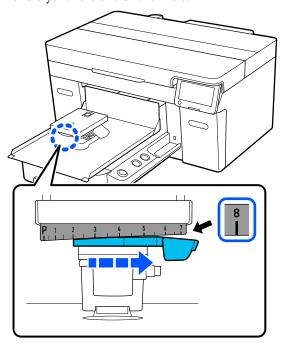
Затяните фиксирующий рычажок, затем зафиксируйте рычаг регулировки зазора печатного стола.
