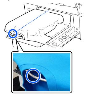
Разгладьте поверхность печати, оттянув в стороны части футболки, которые выходят за края печатного стола.
