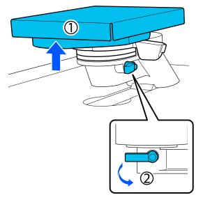
Oсвободите деталь, поднятую на предыдущем этапе, а затем снова затяните фиксирующий рычаг, чтобы зафиксировать рычаг регулировки зазора печатного стола.
