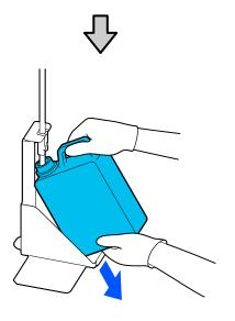
Вставьте трубку для отработанных чернил в отверстие новой Емкости для отработанных чернил и установите Емкость для отработанных чернил в держатель.
