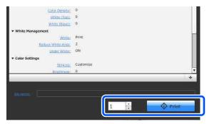
Когда принтер завершит получение задания, область предварительного просмотра откроется на экране принтера и загорится кнопка ◆.
