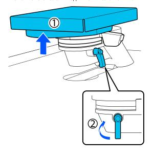
Поднимите рычаг регулировки зазора печатного стола и уберите прокладку.
