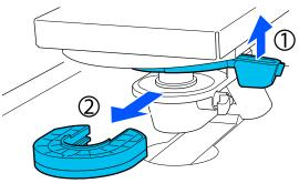
8 Комбинируйте прокладки в зависимости от типа используемого печатного стола и толщины носителя.
