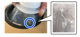
Это результат коагуляции фиксирующего компонента в жидкости для предварительной обработки. Если использовать жидкость для предварительной обработки с коагуляцией, результаты печати будут низкого качества. Поэтому необходимо отфильтровать жидкость перед использованием, чтобы устранить коагуляцию.
