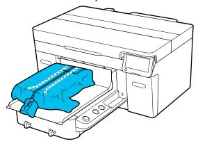
Разгладьте поверхность печати, оттянув в стороны части футболки, которые выходят за края печатного стола.
