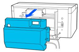
Снимите трубки для отработанных чернил, захватив их снизу с помощью салфетки, как показано на рисунке, а затем вытрите салфеткой отработанные чернила на отверстии для вывода отработанных чернил.
