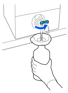
Если осталось немного жидкости для предварительной обработки, наклоните картонный контейнер для его опорожнения.
