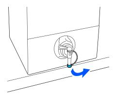
Поверните рычажок, чтобы вылить один литр жидкости для предварительной обработки в емкость через фильтр.
