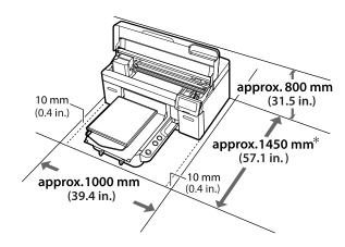
\* Приблизительно 1500 мм (59,1 дюйма), если установлен дополнительный подвесной печатный стол размера L.
