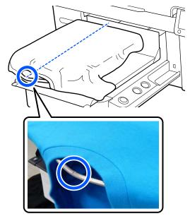
Разгладьте поверхность печати, оттянув в стороны части футболки, которые выходят за края печатного стола.
