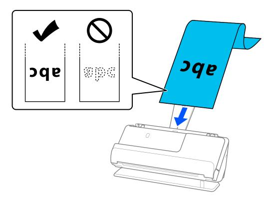
Al cargar el papel largo, sujételo al lado de la entrada para que no se salga ni caiga del ADF, y por el lado de salida para que el papel expulsado no caiga o se salga de la bandeja de salida.
