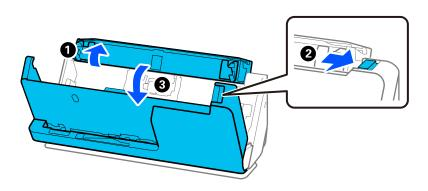
2. Retire la cubierta del rodillo de separación tal como se indica.
