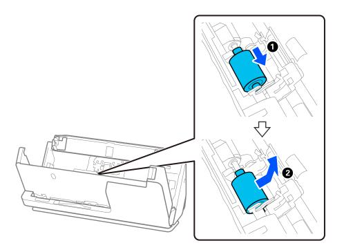
8. Coloque el rodillo de alimentación nuevo en la posición correcta. Inserte las muescas de los extremos del rodillo de alimentación en el eje del escáner, bájelo y deslícelo hacia atrás.
