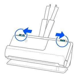
5. Asegúrese de que hay suficiente espacio en frente del escáner para los originales que saldrán expulsados. Coloque su original con el lado «2» hacia el lado de la Hoja Soporte con la ilustración y en el borde de entrada.
