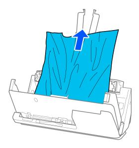
5. Si no puede extraer los originales, extraiga cuidadosamente los originales atascados de la bandeja de salida en la dirección de la flecha.
