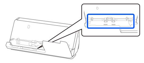
7. **Limpie las manchas de dentro del escáner.** Abra la bandeja de entrada y tire de la palanca para abrir la cubierta del escáner.
