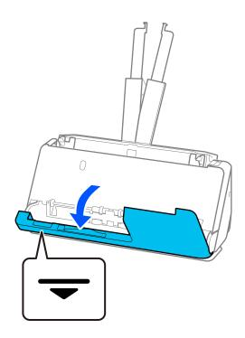
3. Tire de la palanca para abrir la cubierta del escáner.
