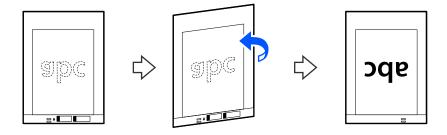
7. Cargue la Hoja Soporte en la bandeja de entrada con el borde superior orientado hacia el ADF. Introduzca el papel en el ADF hasta que encuentre resistencia.
