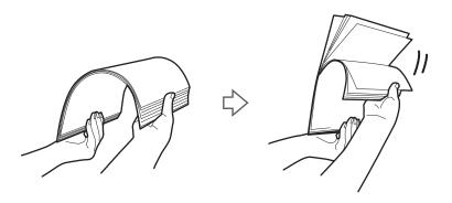
6. Alinee los bordes de los originales y, con el lado a escanear hacia abajo, deslice los bordes delanteros en forma de cuña.
