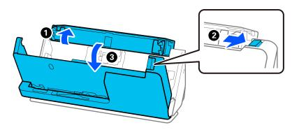
8. Limpie la superficie de cristal del interior de la cubierta del escáner. Límpielo con un paño de limpieza específico o con un paño suave que no suelte pelusa. Si la superficie del cristal está muy sucia, límpiela con un paño suave y sin pelusa humedecido con una pequeña cantidad de limpiador específico o agua.
