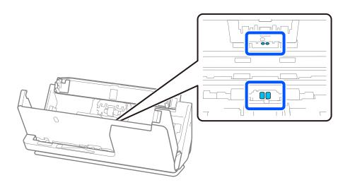
10. Limpie las manchas del rodillo de separación. Abra la cubierta y, a continuación, retire el rodillo de separación.
