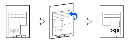
7. Cargue la Hoja Soporte en la bandeja de entrada con el borde superior orientado hacia el ADF. Introduzca la hoja de soporte en el ADF hasta que encuentre resistencia.
