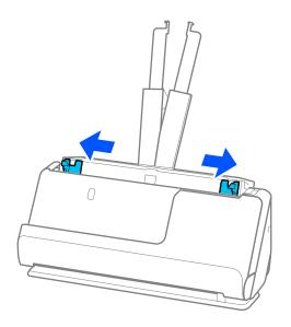
5. Cargue los originales con el lado que desea escanear boca arriba y een orden descendiente en cuanto al tamaño del papel, con el más ancho al final y el más estrecho al principio de la bandeja de entrada.
