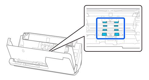
5. Cierre la cubierta del escáner con ambas manos. A continuación, cierre la cubierta del recorrido vertical y luego la bandeja de entrada, en ese orden.
