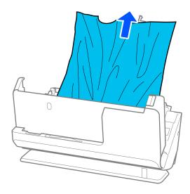
Si no puede extraer los originales, extraiga cuidadosamente los originales atascados de la ranura de salida en la dirección de la flecha.
