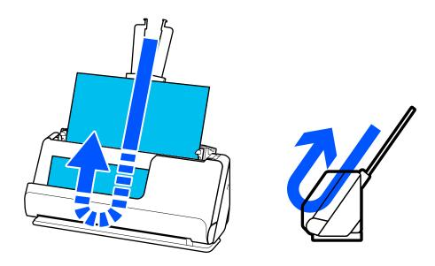
Cuando se cambia la posición del recorrido vertical, el indicador luminoso un en el panel de control se apaga.
