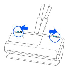
5. Cargue el sobre en orientación vertical con la cara a escanear hacia arriba. Para los sobres en los que el borde abierto (con solapa) está en el lado corto, puede cargar el sobre con el borde abierto (con solapa) hacia arriba. Introduzca el sobre en el ADF hasta que encuentre resistencia.
