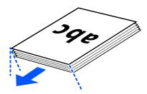
7. Coloque los originales en la bandeja de entrada de ADD boca arriba y con el borde superior orientado hacia el ADF.
