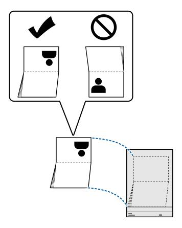
6. Coloque la Hoja protectora para pasaportes con la cara que desea escanear boca arriba y con el borde de entrada orientado hacia el ADF.
