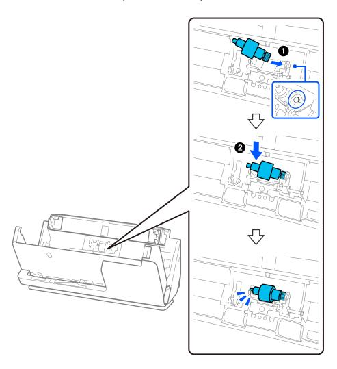
5. Colque la cubierta del rodillo de separación tal como se indica. Inserte el eje de la parte superior de la cubierta en las ranuras y, a continuación, cierre la cubierta con firmeza.
