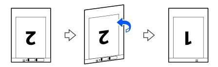
7. Cargue la Hoja Soporte en la bandeja de entrada con el borde superior orientado hacia el ADF. Introduzca el papel en el ADF hasta que encuentre resistencia.
