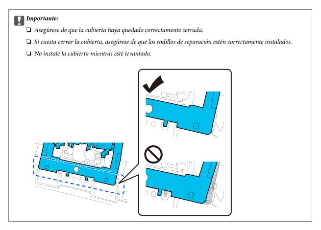
6. Instale la cubierta del rodillo de alimentación.
