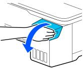
Öffnen Sie die Tintenbehälterdeckel, um die Tinte wiederaufzufüllen.
