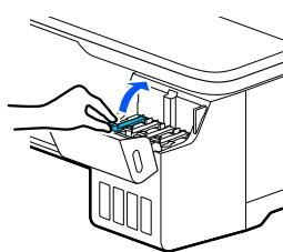
**4** Снимите транспортировочные крышки.
