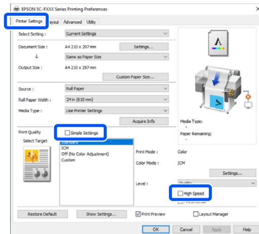
При отмене High Speed Printing (Высокоскоростная печать) печать будет занимать более длительное время. Если скорость печати является основным приоритетом, попробуйте выполнить следующие действия для уменьшения Color Density (плотность чернил).
