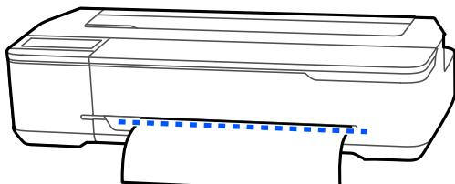
Линии отреза невозможно печатать дальше нижнего поля. После завершения перемещения бумаги нажмите кнопку (Отрезать). Отображается экран обрезки или выбора линии отреза.
