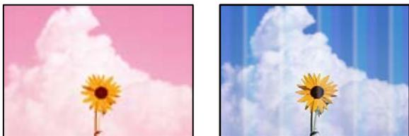
■ **Los inyectores del cabezal de impresión pueden estar obstruidos.**
