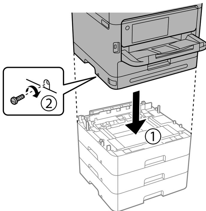
12. Fixez les bacs à papier en option et l'imprimante à l'arrière et sur le côté droit à l'aide de vis.
