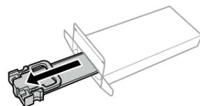
**9** Vložte zásobník inkoustu do jednotky zásobníku. Illesze a tinta-adagoló egységet a tintatálcába. Nasadte jednotku zásobníka s atramentom do zásobníka atramentu.
