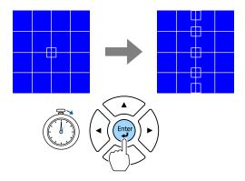
• Utilisez les boutons fléchés gauche et droite pour sélectionner la colonne que vous souhaitez ajuster, et appuyez sur [Enter].
