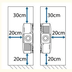
• N'installez pas le projecteur dans un endroit qui ne permet pas à l'air de circuler, par exemple sur une étagère ou dans une boîte.
