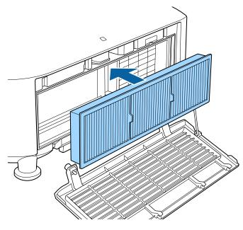
Remplacez le capot du filtre à air comme indiqué et serrez les vis.
