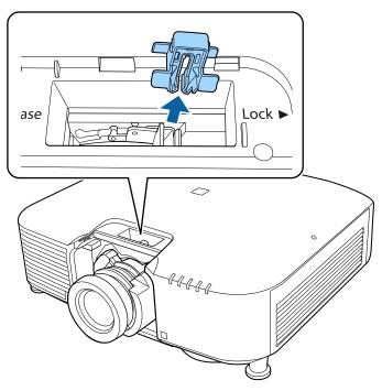
Tenez fermement l'objectif en pinçant le levier de verrouillage et déplacezle vers la position **Release**.
