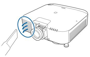
Desserrez les vis et retirez le capot du filtre à air comme illustré (il est fixé avec une attache).
