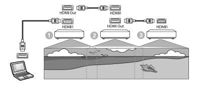
Connectez le projecteur à l'ordinateur avec le câble HDMI, puis connectez le port HDMI1 In et le port HDMI Out des projecteurs avec le câble HDMI.
