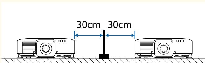
Місце встановлення (при встановленні додаткового зовнішнього повітряного фільтру)
