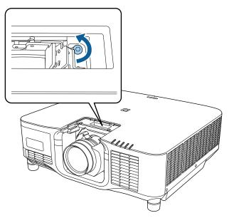
Sostenga la lente firmemente mientras aprieta la palanca de bloqueo y la mueve a la posición **Release**.
