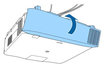
Apriete los tornillos de la cubierta de los cables.
