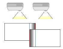
• Seleccione la configuración **Curva de mezcla** y seleccione un gradiente para el área sombreada en los proyectores.
