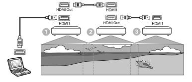
Conecte el proyector al ordenador mediante el cable HDMI y, a continuación, conecte los puertos HDMI1 In y HDMI Out de los proyectores con dicho cable.
