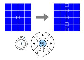
• Use los botones de flecha izquierda y derecha para seleccionar la columna que desee ajustar y pulse [Enter].
