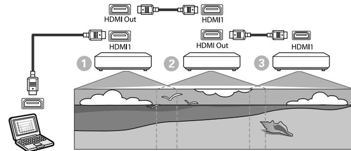
**1** Ligue o projetor ao computador utilizando o cabo HDMI e, em seguida, ligue a porta HDMI1 In e a porta HDMI Out do projetor utilizando o cabo HDMI.
