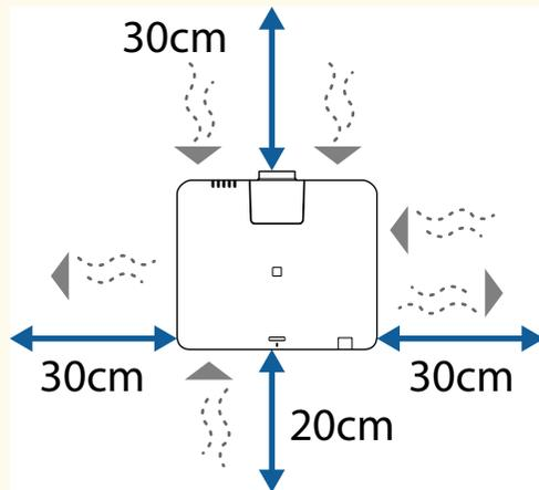
Einzelheiten zur Position der Zuluft- und Abluftöffnungen finden Sie in den *Specifications* des Projektors.
