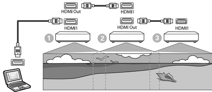
**1** Verbinden Sie den Projektor über das HDMI-Kabel mit dem Computer und verbinden Sie dann den HDMI1 In-Anschluss und den HDMI Out-Anschluss der Projektoren über das HDMI-Kabel.
