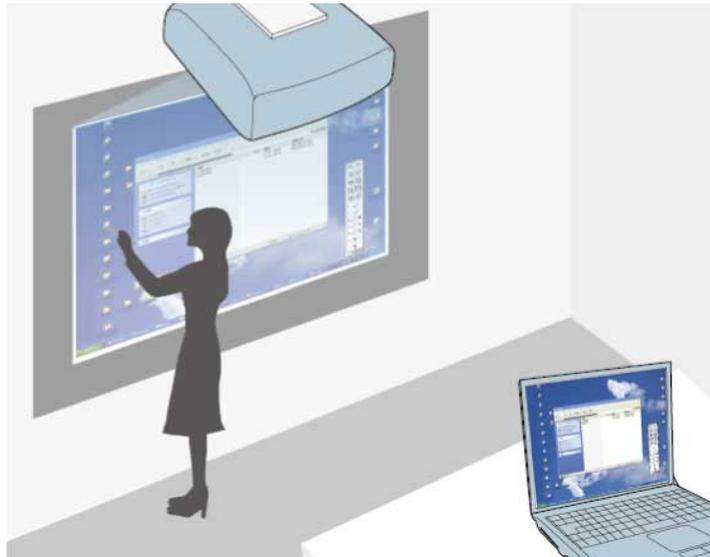
Wenn der Projektor über ein USB-Kabel mit einem Computer verbunden ist, können Sie den Computer mit Hilfe der interaktiven Stifte oder Ihres Fingers (EB-695Wi/EB-680Wi) wie mit einer Maus von der Projektionsfläche aus steuern. Sie können von der Projektionsfläche aus navigieren, auswählen und mit Ihren Computerprogrammen interagieren.
