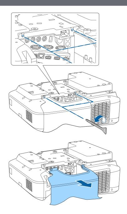
Connectez le module LAN sans fil à l'emplacement du module LAN sans fil.
