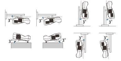
Si vous inclinez le projecteur de plus de 3°, il risque de tomber et d'être endommagé ou de provoquer un accident.
