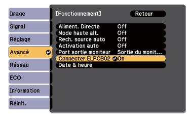
La source d'entrée bascule entre HDMI2 et HDMI3 à chaque fois que vous appuyez sur le bouton [HDMI2] sur le boîtier d'interface.
