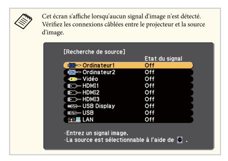
• Appuyez sur le bouton de la source souhaitée sur la télécommande. S'il y a plus d'un port pour cette source, appuyez à nouveau sur le bouton pour défiler entre les sources.
