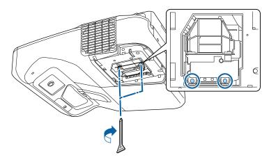
Remettez le couvercle de la lampe en place et serrez les vis pour le maintenir en place.
