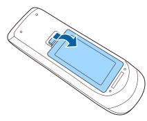
Insérez les piles avec les extrémités + et - orientées de la manière indiquée.
