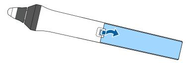
Insérez les piles avec les extrémités + et – orientées de la manière indiquée.
