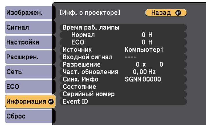
Доступные параметры зависят от текущего источника входного сигнала. Таймер использования лампы не регистрирует ее часы работы до тех пор, пока она не проработает мин. 10 часов.
