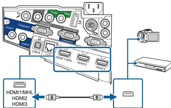
Если при прослушивании звука через HDMI-соединение имеются проблемы, подключите один конец приобретаемого отдельно 3,5 мм стерео аудиокабеля с разъемом мини-гнездо к порту Audio, а другой конец к выходному аудиопорту источника видеосигнала. Выберите аудио вход, подключенный в меню **Расширен.** проектора.
