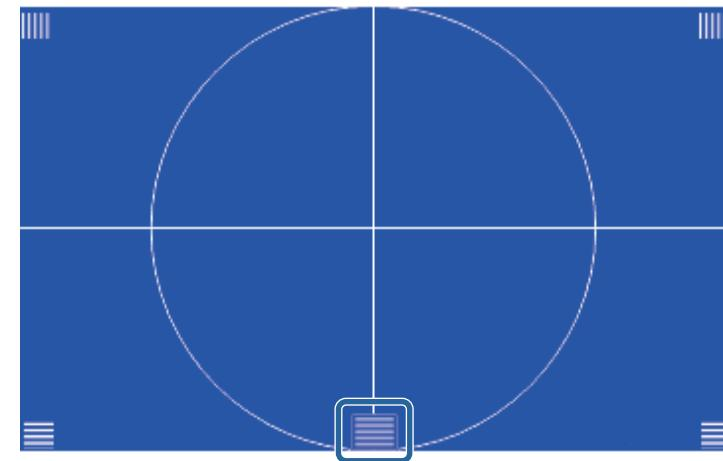
**7** Проверьте фокусировку по углам проецируемого экрана.
