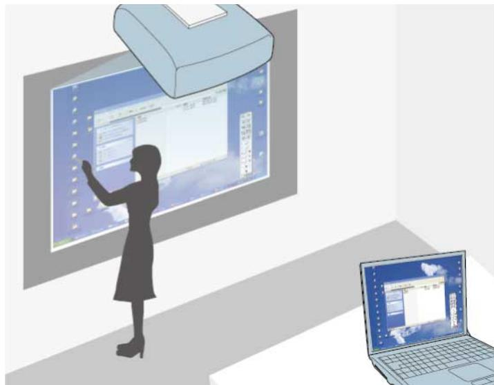
При подключении проектора к компьютеру с использованием кабеля USB можно управлять компьютером с проецируемого экрана с помощью интерактивного пера или пальца (EB-695Wi/EB-680Wi) вместо мыши. Вы сможете перемещаться, выбирать и взаимодействовать с компьютерными программами с проецируемого экрана.
