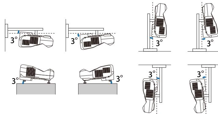
Использование проектора при наклоне более 3° может стать причиной его повреждения и несчастного случая.
