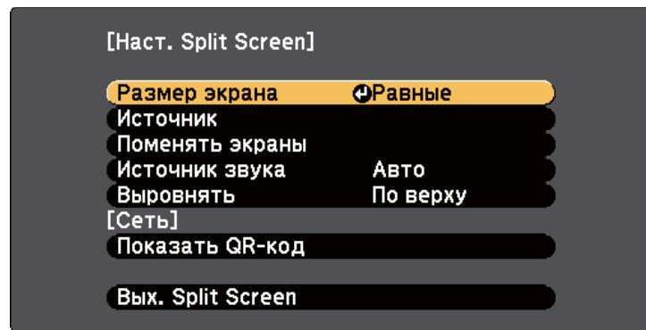
**3** Для выбора источника входного сигнала выберите параметр **Источник**, нажмите кнопку [Enter], выберите источник входного сигнала, затем значение **Выполнить** и нажмите кнопку [Enter].
