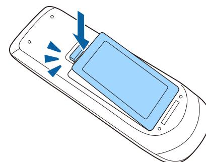
В интерактивном пере можно использовать марганцевую батарейку АА, щелочную батарейку АА или аккумуляторную батарейку Eneloop (BK-3MCC). Когда батарейки разряжаются, их необходимо заменить. Если батарея разряжена индикатор мигает при нажатии на кнопку, расположенную сбоку пера. Когда батарейка разряжается, индикатор пера гаснет.
