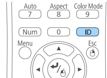
На проецируемом экране отображается ID текущего проектора.
