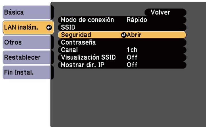
**7** Seleccione la configuración de seguridad para que coincida con la configuración de la red.
