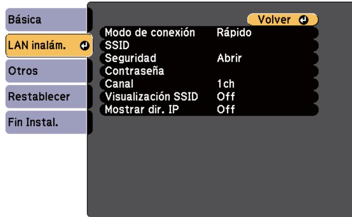
**8** Seleccione la configuración de **Modo de conexión**.
