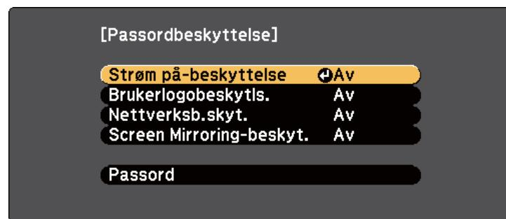
Hvis du ikke ser denne menyen, holder du nede [Freeze]-knappen på fjernkontrollen i 5 sekunder til menyen vises.
