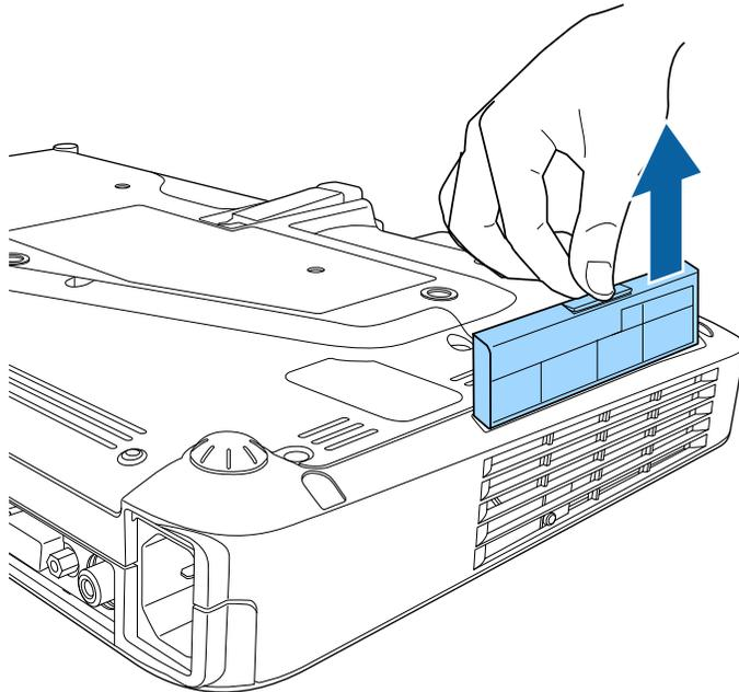
**3** Coloque o novo filtro do ar no projector conforme indicado e carregue cuidadosamente até este encaixar correctamente.
