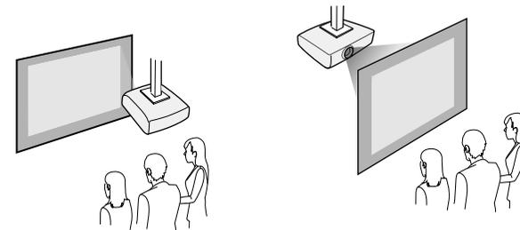
Selecione a opção de **Projecção** correcta no menu **Avançado** do projector, de acordo com o método de instalação utilizado.
