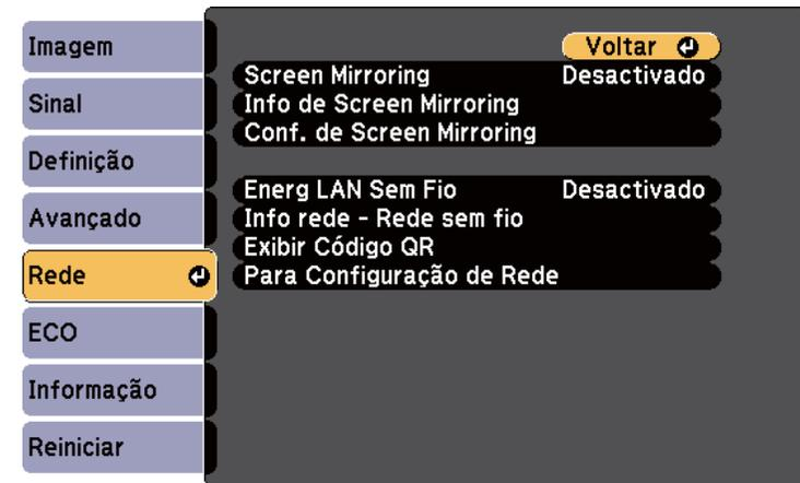
**3** Seleccione **Activado** na definição **Energia LAN Sem Fio**.
