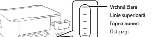
5 Vložte nádobku na a trument rovnou do portu a napláňte a trumentom po vrchnú čiaru.
