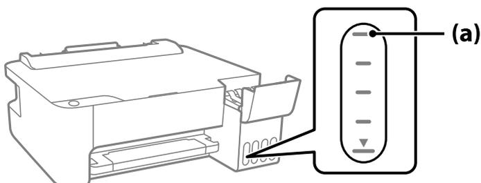
5. Alignez le sommet du flacon avec la goutte de remplissage, puis insérez-le dans celle-ci pour remplir l'encre jusqu'à ce qu'elle atteigne la ligne supérieure et que l'écoulement s'arrête automatiquement.
