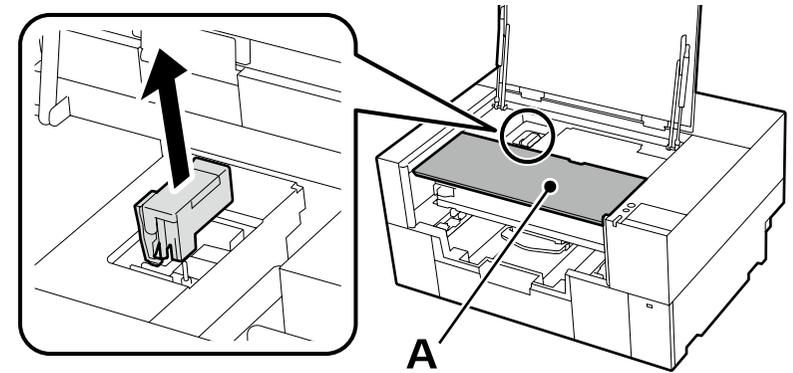
Når du fjerner blækpåfyldningsenheden, må du ikke lægge belastning på del A, der vises på illustrationen ovenfor. Delen kan blive deform, og det er måske ikke længere muligt at udskrive korrekt.
