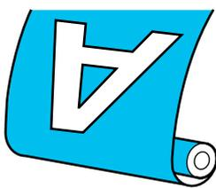
La recogida con el lado impreso dentro sitúa la superficie impresa en la parte interna del rollo. En la mayoría de las situaciones se recomienda el “lado impreso hacia dentro”.
