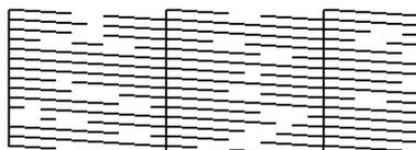
Si faltan partes del patrón de comprobación, pulse **NB** y, a continuación, seleccione Limpieza cabezal impr.
