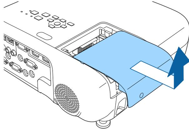
**6** Erfassen Sie den erhöhten Teil der Lampe und entfernen Sie.
