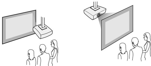
Achten Sie darauf, die entsprechend der verwendeten Installationsmethode richtige **Projektion**-Option im Projektormenü **Erweitert** zu wählen.
