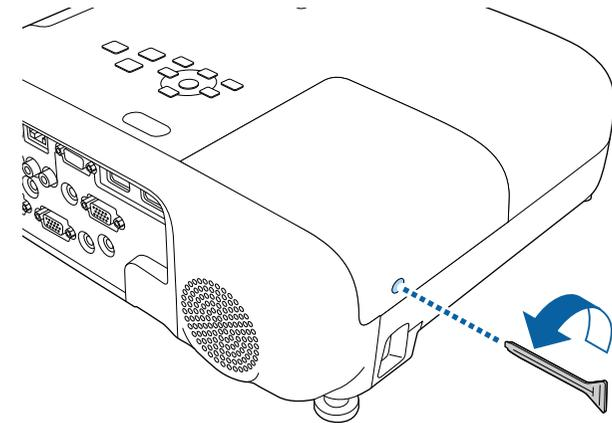
**4** Schieben Sie die Lampenfachabdeckung heraus und heben Sie sie ab.
