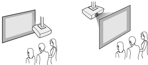
Asegúrese de seleccionar la opción de **Proyección** correcta en el menú **Extendida** del proyector, conforme al método de instalación utilizado.
