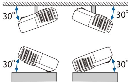
Si utiliza el proyector con una inclinación superior a los 30°, éste podría sufrir daños y causar un accidente.
