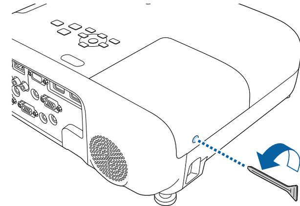
**4** Deslice la cubierta de la lámpara hacia afuera y levántela.
