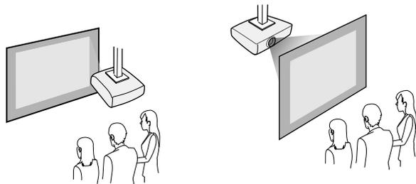
Seleccione a opção de **Projectção** correcta no menu **Avançado** do projector, de acordo com o método de instalação utilizado.
