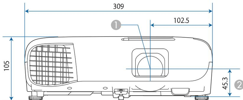
② Distância entre o centro da lente e os pontos de fixação do suporte para montagem no tecto
