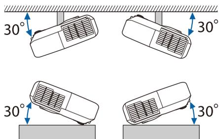
Se utilizar o projector com um ângulo de inclinação superior a 30°, este poderá ficar danificado ou provocar um acidente.
