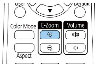
A imagem projetada é ampliada a partir do centro da imagem. Pode ampliar a imagem de uma a quatro vezes, em incrementos de 25.
