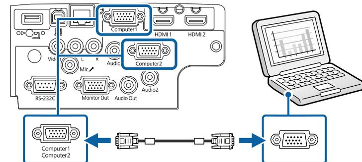
**3** Aperte os parafusos do conector VGA.
