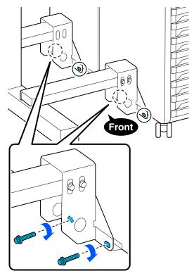
Fissare il coperchio come mostrato nell'illustrazione e fissare le viti.
