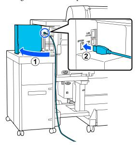
Collegare il cavo all'unità a bobina per il prelievo automatico.
