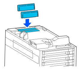
Allineare la stampante e la soluzione di inchiostro sfuso come mostrato nell'illustrazione e fissare la vite.
