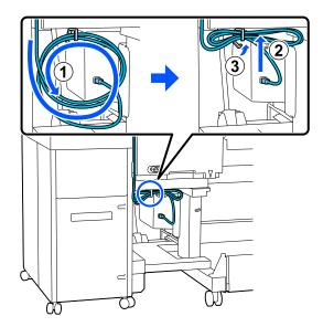
Collegare il cavo di alimentazione all'unità a bobina per il prelievo automatico.
