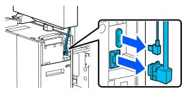
Sollevare la leva sul connettore del tubo dell'inchiostro per la soluzione di inchiostro sfuso ed estrarla.
