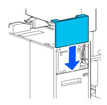
Fissare il coperchio della soluzione di inchiostro sfuso come mostrato nell'illustrazione e fissare le viti.
