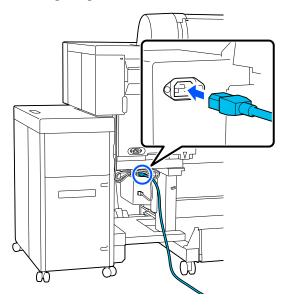
Fissare il cavo di alimentazione con il morsetto, come indicato nell'illustrazione.
