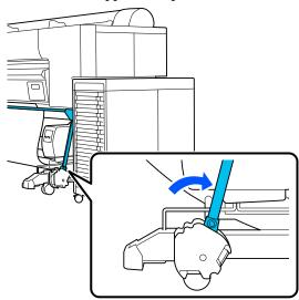
☐ Il sensore fissato al supporto è abbassato e la rotella anteriore è rivolta in avanti.
