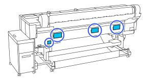
Se la stampante è particolarmente sporca, inumidire il panno con acqua e una piccola quantità di detergente neutro e strizzarlo a fondo prima di utilizzarlo per strofinare la superficie della stampante. Quindi, utilizzare un panno morbido per eliminare l'umidità restante.
