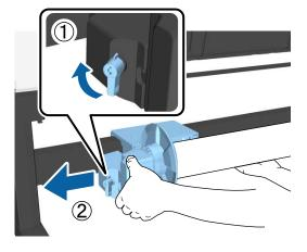
Rimuovere l'anima del rotolo dall'unità a bobina per il prelievo automatico.
