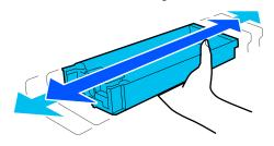
☐ Auf den entfernten Tinten-Versorgungs-Einheiten kann sich rund um die Tintenversorgungsöffnungen Tinte befinden. Berühren Sie deshalb die Tintenversorgungsöffnung nicht, wenn Sie die Tinten-Versorgungs-Einheiten entfernen.
