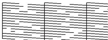
Realizar uma limpeza da cabeça se houver falhas no padrão de verificação dos jatos.
