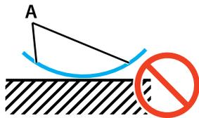
Se a margem do suporte de impressão levantar quando prima em
