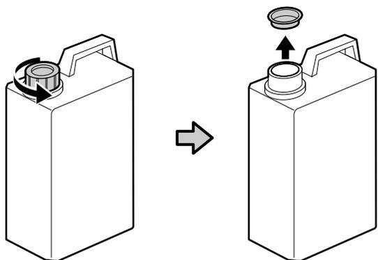
Vrchnák nádobka na odpadový atrament je potrebný vtedy, keď sa likviduje odpadový atrament. Vrchnák si nechajte. Nevyhadzujte ho.
