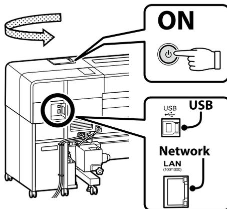
Pred začatím inštalácie povolte pripojenie medzi touto tlačiarňou a počítačom. Pripojte počítač k internetu a stiahnite a nainštalujte softvér. Pripojenie tejto tlačiarne k počítaču pomocou kábla sa musí vykonať podľa pokynov na obrazovke počas inštalácie. Ak tak urobíte vopred, nebude možné nainštalovať základný softvér.
