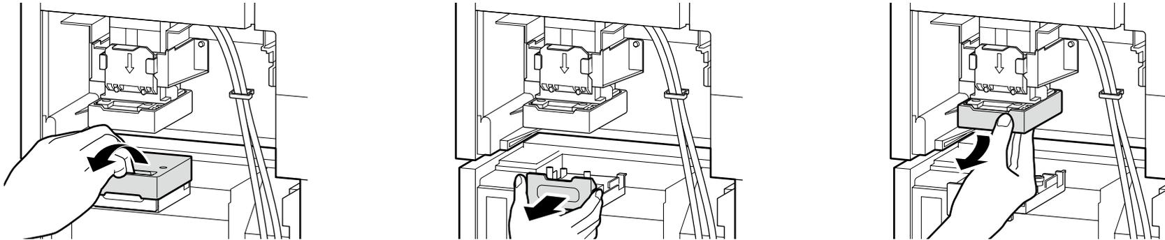
[ 7 ] Potiahnite gombík smerom k sebe a dbajte na to, aby ste podopreli strany dielu. Spustite diel tak, ako je a pripojte ho tak, že zarovnáte výstupok s otvorom označeným značkou ▲.
