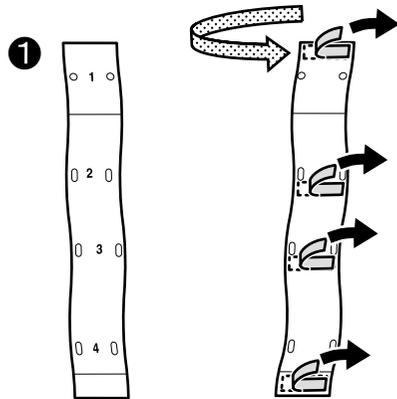
Pripevnite vodiace lišty 1 na ľavú aj pravú stranu tak, aby zapadli do otvorov 1-4 so skrutkami na konci ohrievača.
