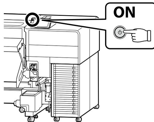
Úvodné nastavenie začína vtedy, keď sa tlačiareň zapne po prvýkrát. Zvoľte jazyk a pomocou pokynov na obrazovke nastavte čas a vyberte merné jednotky. V prípade série SC-F9500H nakonfigurujte aj nastavenia pre súpravu atramentu. Vyberte atramentovú súpravu, ktorú ste zakúpili.
