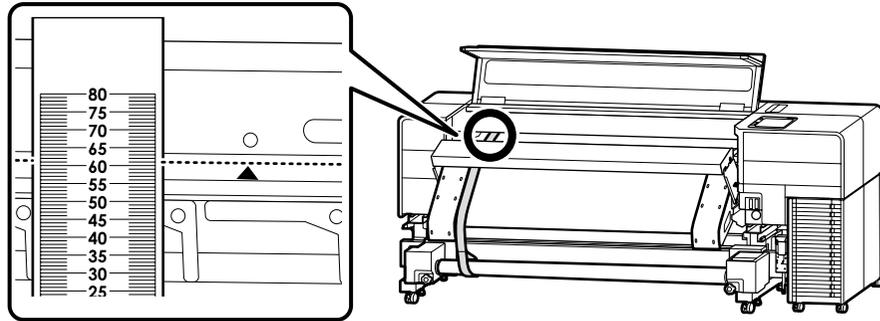
Podobne na strane oproti ovládaciemu panelu, poznačte si hodnotu, pri ktorej sa okraj označený značkou ▲ na tlačiarňi prekrýva so stupnicou na nastavovacej fólii.
