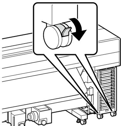
Pred používaním tlačiarne sa uistite, že podstavec je pripevnený na miesto. Pri pohybovaní tlačiarňou odomknite kolieska.
