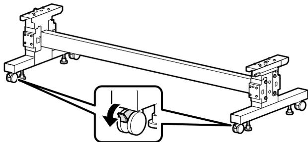
Pred používaním tlačiarne sa uistite, že podstavec je pripevnený na miesto. Pri pohybovaní tlačiarňou odomknite kolieska.
