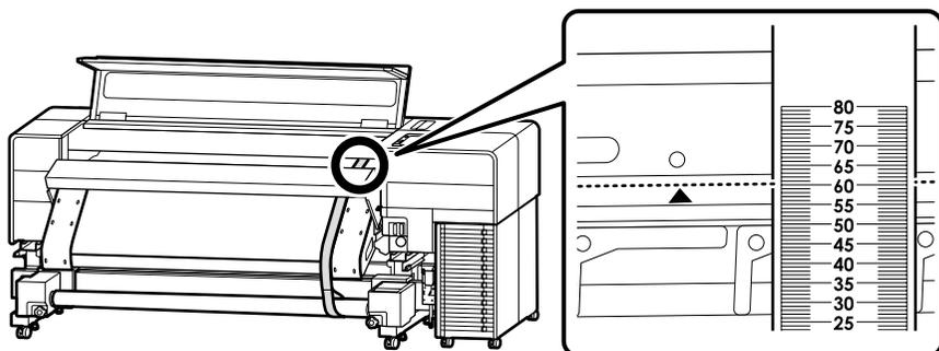
Poznačte si hodnotu, pri ktorej okraj označený značkou ▲ na tlačiarni prekrýva stupnicu na nastavovacej fólii.
