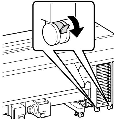
**Før anvendelse af printeren skal du sikre dig, at stativet står fast. Lås hjulene op, når du flytter printeren.**
