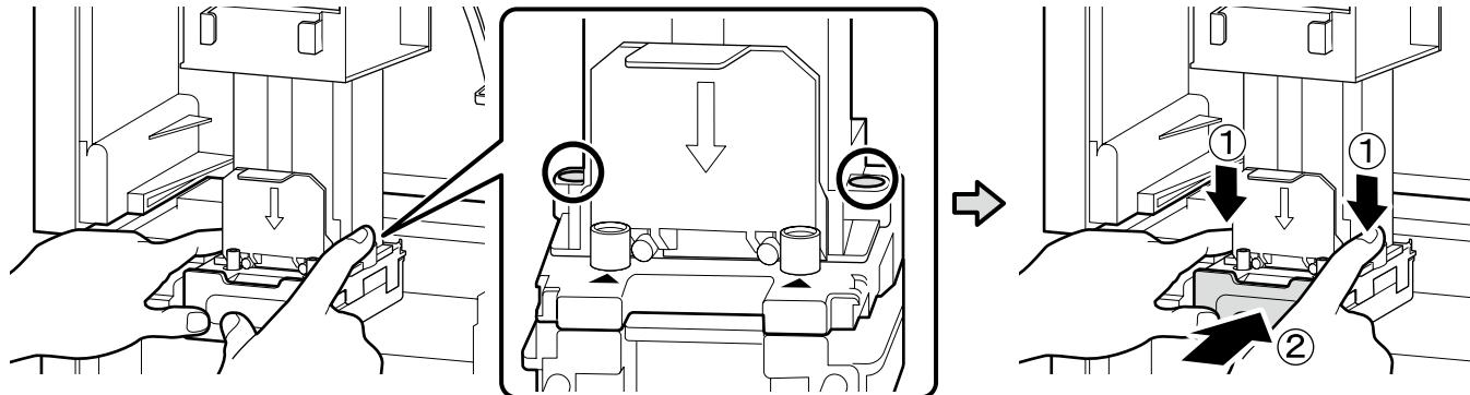
For at tilslutte blækstien sikkert skal du låse håndtaget, mens du trykker hårdt på delene, der er omringet af ○, ovenfra med begge hænder.
