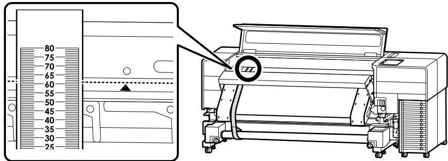
Samtidigt på modsatte side af kontrolpanelet skal du registrere værdien, hvor kanten indikeret af mærket ▲ på printeren overlapper skalaen på justeringsfilmen.
