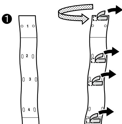
Fastgør styrene ① til både venstre og højre side for at tilpasse hullerne 1-4 til skruerne for enden af varmeren.
