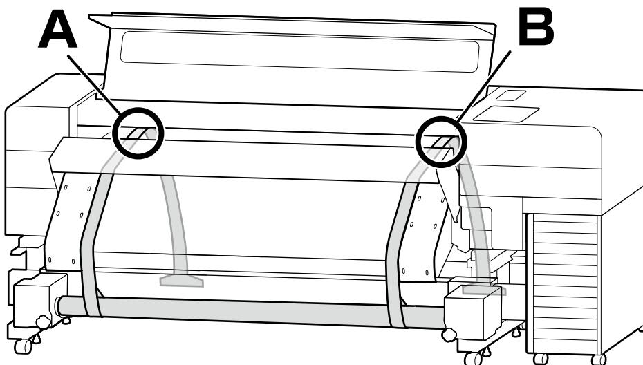
Udfør parallel justering for at få længden af printstien til at flugte på venstre og højre side (A og B på figuren).
