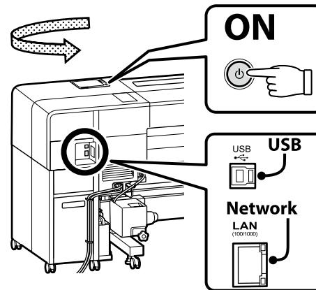
Før du starter installationen, skal du aktivere forbindelsen mellem denne printer og computeren. Forbind computeren til internettet for at downloade og installere softwaren. Forbindelsen mellem denne printer og computeren via et kabel skal udføres ved at følge instruktionerne på skærmen under installationen. Hvis du gør det på forhånd, kan den grundlæggende software ikke installeres.
