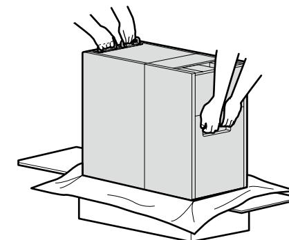
Når du fjerner 1 fra boksen, skal du holde fast i de dele, der vises på figuren, og I skal være to personer til at løfte.
