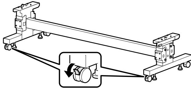
Før anvendelse af printeren skal du sikre dig, at stativet står fast. Lås hjulene op, når du flytter printeren.
