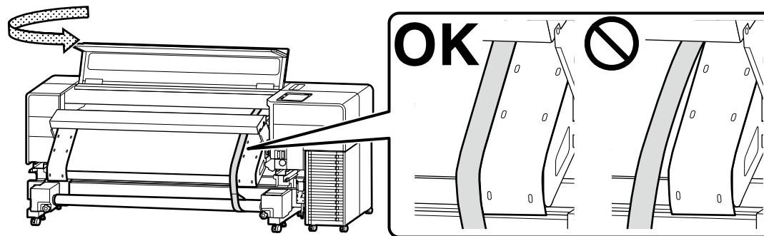
Sørg for at få justeringsfilmen til at flugte med styret.
