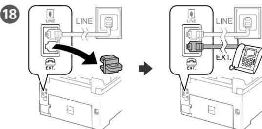
Če želite uporabljati isto telefonsko linijo kot za telefon, odstranite pokrovček in priključite telefon na priključek EXT.
