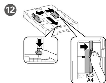
Primite in podrsnite vodila za robove.
