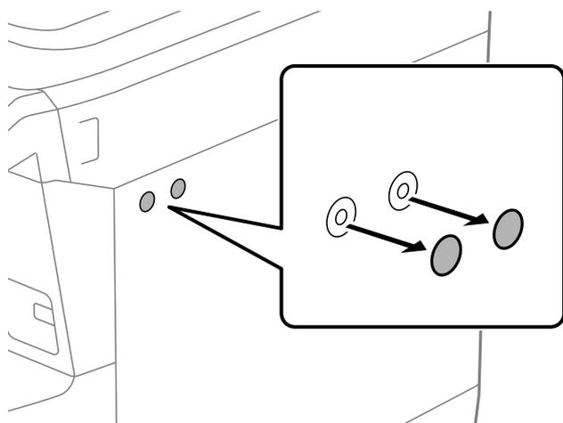
2. Utilize uma chave de fendas para apertar os dois parafusos (e) e fixar a placa metálica (g).
