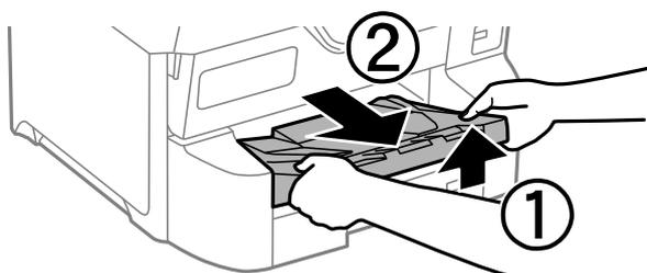
4. Remova a unidade de alimentação de papel opcional da caixa e, de seguida, remova quaisquer materiais de proteção.
