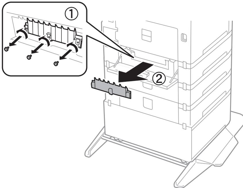
6. Deslize os dois cilindros de recolha usados para fora e retire-os.
