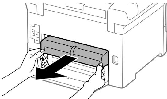
6. Retire a tampa no interior da parte posterior da impressora.
