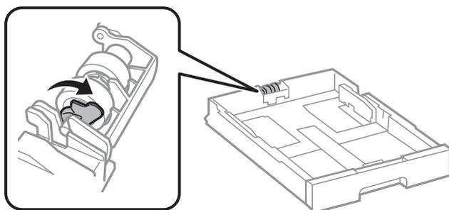
13. Deslize o cilindro de recolha na direção da alavanca e, a seguir, retire-o retirando o eixo do suporte.
