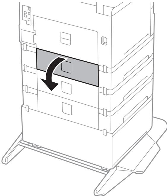
5. Retire os parafusos com uma chave de fendas e retire a tampa posterior do interior da impressora.
