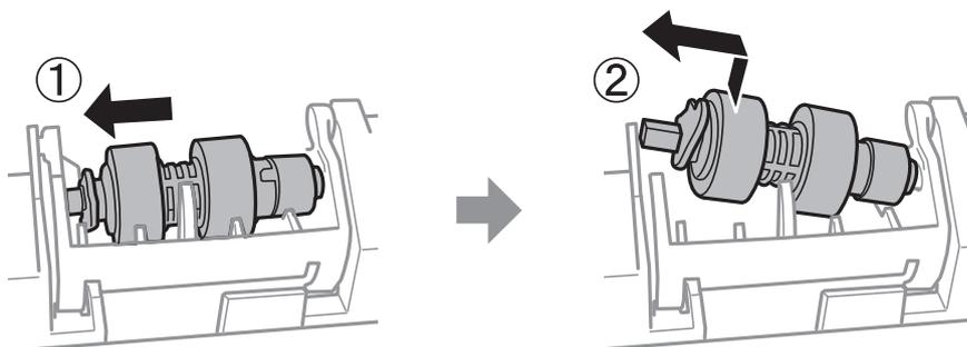
14. Introduza o eixo do novo cilindro de recolha no orifício do suporte e, a seguir, faça deslizar o eixo do lado da alavanca ao longo da ranhura, enquanto está virado para a superfície plana na frente.
