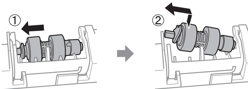
12. Introduza o eixo do novo cilindro de recolha no orifício do suporte e, a seguir, faça deslizar o eixo do lado da alavanca ao longo da ranhura, enquanto está virado para a superfície plana na frente.
