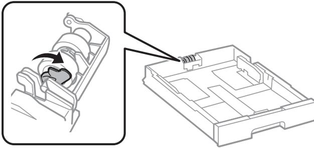
11. Deslize o cilindro de recolha na direção da alavanca e, a seguir, retire-o retirando o eixo do suporte.
