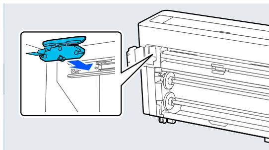
**7** Resserrez la vis qui fixe la coupeuse à l'aide d'un tournevis cruciforme.
