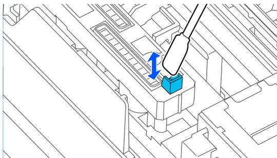
(4) In caso di lanugine o polvere nei cappucci, rimuovere con la punta del bastoncino di pulizia o con una pinzetta.
