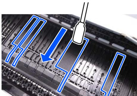
Utilizzare un bastoncino sottile per pulire le superfici tra le scanalature sottili e l'interno delle pareti laterali, come illustrato di seguito.
