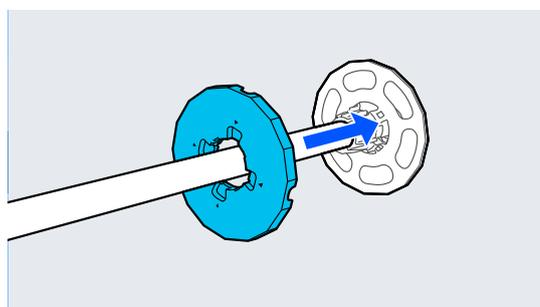
**8** Fissare la guida laterale del supporto trasparente al mandrino.
