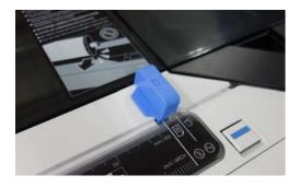
Se o original ainda não puder ser alimentado corretamente, altere **Dim orig** ou **Área Digit.** para o tamanho padrão a partir de **Detecção Automática**.
