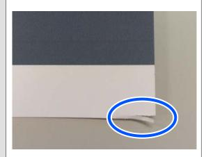
Selecione Definições gerais — Definições da impressora — Def. origem do papel — Configurar papel em rolo — Definições de corte — Corte Rápido — Desactivado no painel de controlo.
