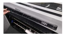
Se a ranhura de scanner sair, abra a tampa do scanner e depois instale a ranhura de scanner.
