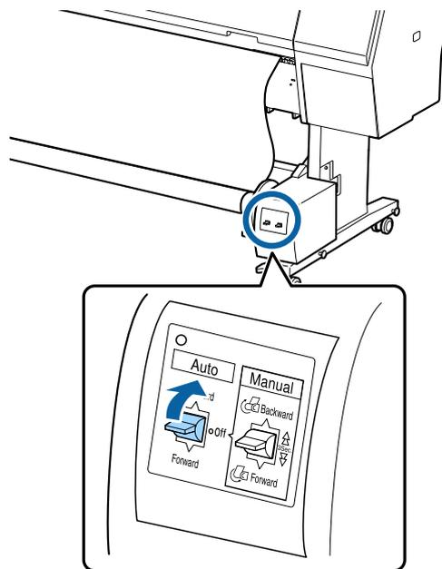
**Rimozione della carta dall'unità a bobina per il prelievo automatico**
