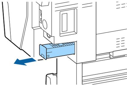
**3** Posizionare la tanica di manutenzione usata nel sacchetto trasparente fornito con la nuova tanica di manutenzione, e assicurarsi che la cerniera sia chiusa stretta.
