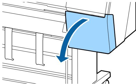
**4** Снимите переднюю служебную крышку.
