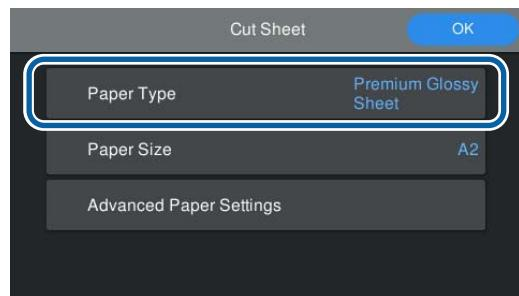
Если отображаемый на экране тип бумаги не соответствует типу загруженной бумаги, нажмите пункт **Тип бумаги**, чтобы задать этот параметр.
