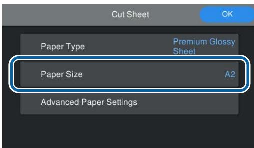
Если отображаемый на экране размер бумаги не соответствует размеру загруженной бумаги, нажмите пункт **Размер бумаги**, чтобы задать этот параметр.
