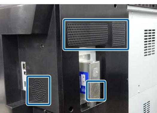
Чтобы удалить сильные загрязнения, смочите салфетку водой с небольшим количеством нейтрального моющего средства, отожмите ее насухо и протрите поверхность принтера. Затем протрите принтер сухой салфеткой для удаления оставшейся влаги.
