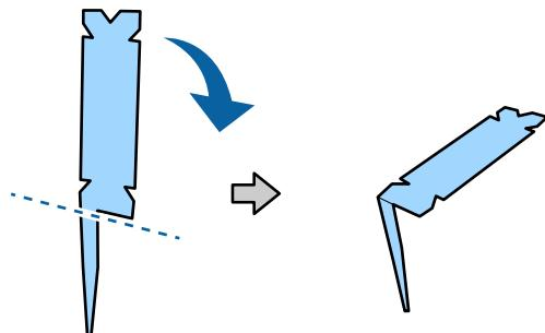
Согните прокладку, отмеченную звездочкой (\*) на рисунке «Дополнительное оборудование и расходные материалы», так, как показано на схеме.
