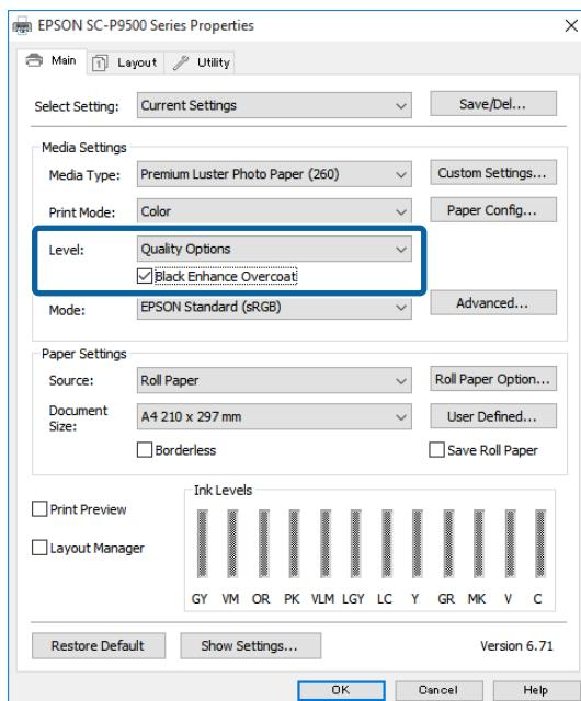
При выборе функции **Покрытие для улучшения черного** у края бумаги печатается более широкое поле. При выборе функции **Минимизация верхнего поля** ширина полей у края бумаги уменьшается, но при этом также снижается качество изображения на этих уменьшенных полях.
