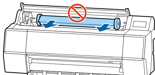
**6** Поднимите рычаги блокировки адаптеров, чтобы снять фиксаторы, и снимите адаптеры рулонной бумаги с рулона.
