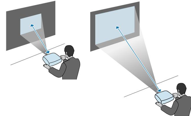
Wählen Sie die entsprechend der verwendeten Installationsmethode richtige **Projektion**-Option im Projektormenü **Installation**. Stellen Sie bei Bedarf die **Menüdreherung** im **Display**-Menü des Projektors ein.
