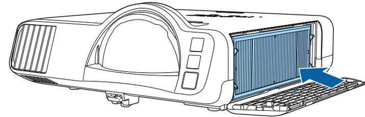
**5** Schließen Sie die Abdeckung des Luftfilters.
