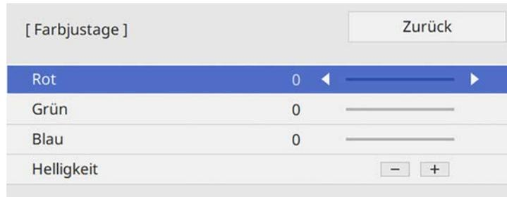
Mit den Tasten **Helligkeit** passen Sie die RGB-Werte gleichzeitig an.
