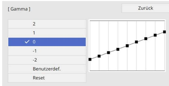
Durch Auswahl eines kleineren Wertes können Sie die Gesamthelligkeit des Bildes reduzieren, damit es schärfer dargestellt wird. Durch Auswahl eines größeren Wertes werden dunklere Bildbereiche heller, während jedoch die Farbsättigung in helleren Bereichen abnimmt.
