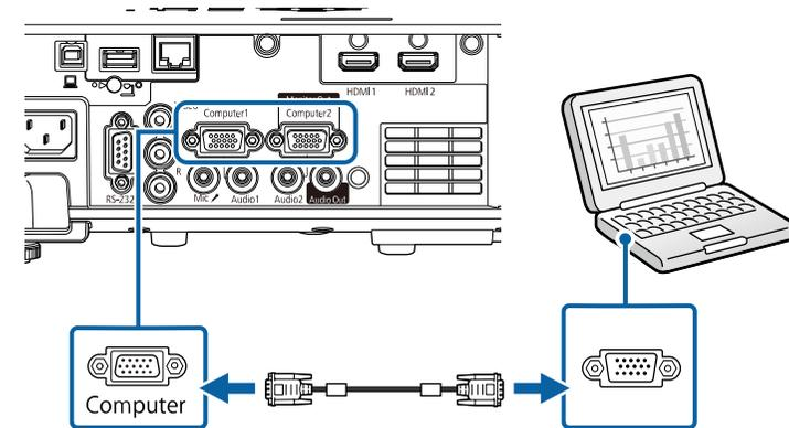
**3** Ziehen Sie die Schrauben am VGA-Anschluss fest.
