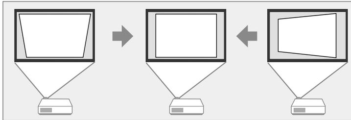
Über die Trapezkorrektur-Tasten können Sie Bilder um bis zu 15° nach rechts, links, oben oder unten korrigieren.
