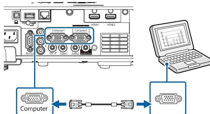
**3** Trekk til skruene på VGA-kontakten.
