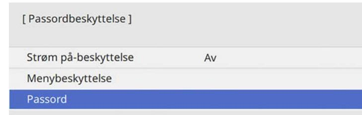
Hvis du ikke ser denne menyen, holder du nede [Freeze]-knappen på fjernkontrollen i 5 sekunder til menyen vises.
