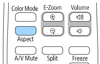
Formen og størrelsen på det viste bildet endres, og navnet på bredde/høyde-forhold vises såvidt på skjermen.
