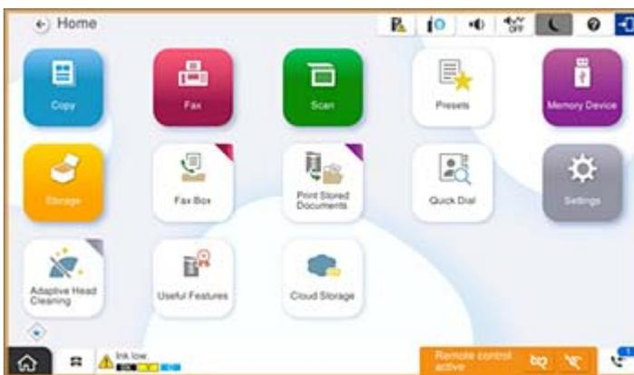
Das ist der Bildschirm, der angezeigt wird, wenn Sie Einstellungen in Web Config vornehmen, die verhindern sollen, dass der Benutzer die Fernverbindung trennt oder den Fernbedienungsbildschirm während der Bedienung des Bedienfelds des Druckers ausblendet. Das Fernbedienungsmenü wird nicht unten rechts angezeigt.
