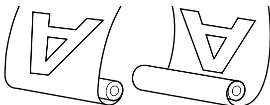
La recogida con la cara impresa hacia arriba coloca la superficie impresa en la parte exterior del rollo.
