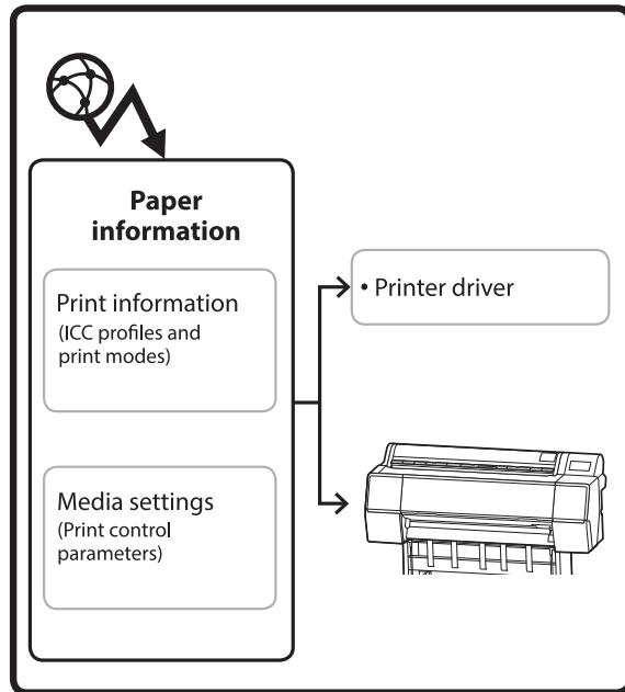
La información del papel, incluidos los perfiles ICC, los modos de impresión y los parámetros de control de impresión, se descarga de servidores. La información del papel descargada se guarda en el controlador de la impresora o en la propia impresora.
