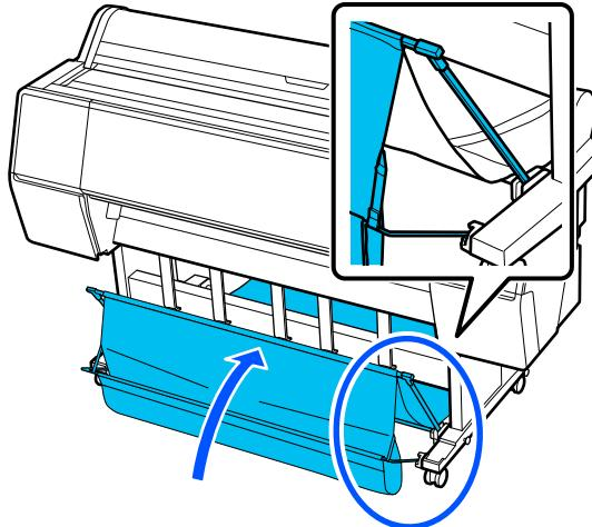
Cuando el papel toque el suelo, asegúrelo con el gancho y la cinta de sujeción, como se muestra en la ilustración.
