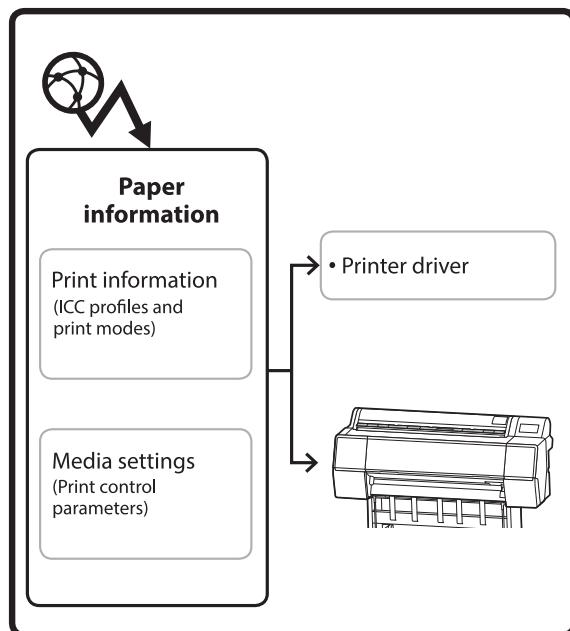
La información del papel, incluidos los perfiles ICC, los modos de impresión y los parámetros de control de impresión, se descarga de servidores.
