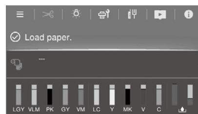
Ta operacja jest wykonana, po wyświetleniu na wyświetlaczu komunikatu „Załaduj papier.”
