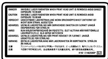
Este é um produto de díodo laser de Classe IIIb que possui um raio laser invisível. A cabeça de impressão NÃO PODE SER REPARADA. Como tal, a cabeça de impressão não deve ser aberta em nenhuma circunstância. É colocada uma etiqueta adicional de aviso de laser adicional no interior da impressora.
