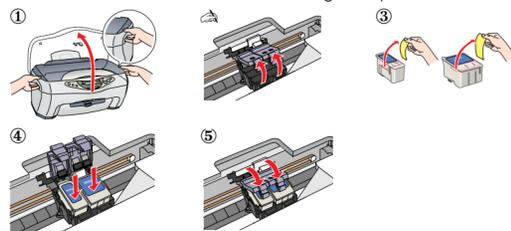
**Nota:** Instale ambos os tinteiros. Se os tinteiros não estiverem correctamente instalados, o produto não funciona.
