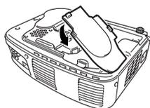
5. Remonter le couvercle. Insérez les crochets dans une direction diagonale jusqu'à ce que vous entendiez les 2 crochets se mettre en place. Veillez à ce que les crochets soient attachés en toute sécurité.
